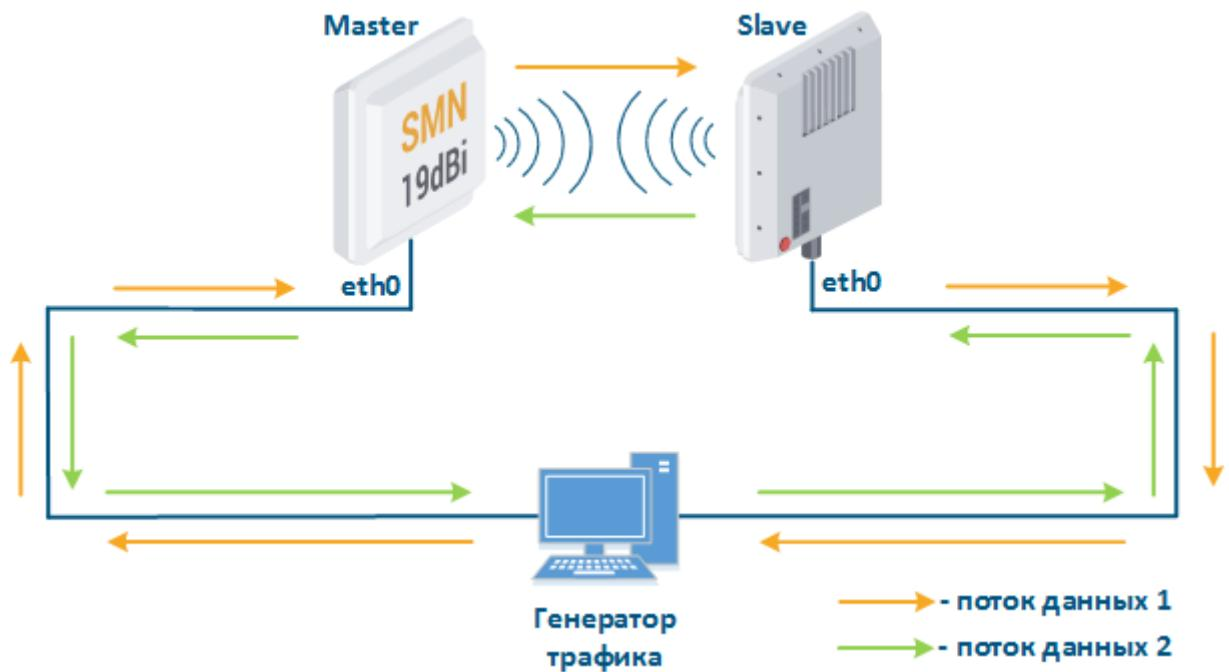
Рисунок 2 - Двунаправленный тест пропускной способности
