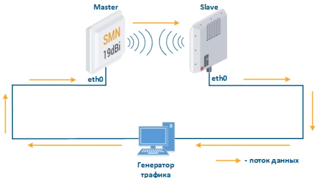
Рисунок 1 - Односторонний тест пропускной способности
