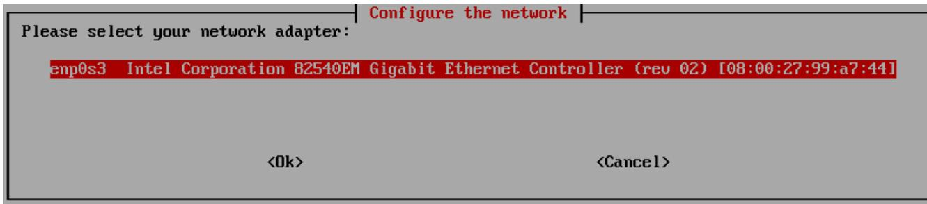
Рисунок - Сетевые параметры: выбор сетевого адаптера
