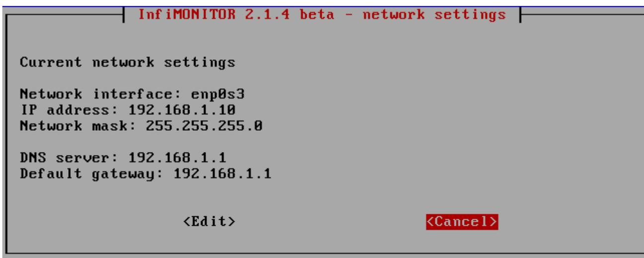
Рисунок - Сетевые параметры: сводная информация
