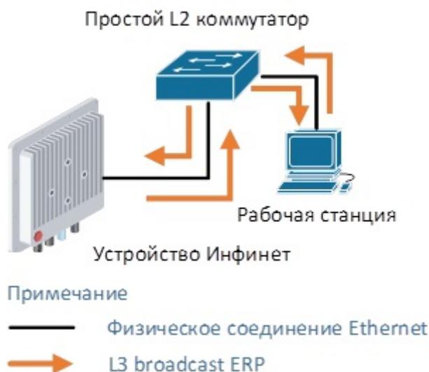
Рисунок - рекомендуемая схема подключения
