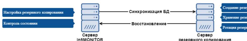
Для обеспечения безопасности система мониторинга InfiMONITOR должна быть авторизована на сервере резервного копирования, для чего применяется специальный пароль, который может быть изменен в сервисном режиме.
