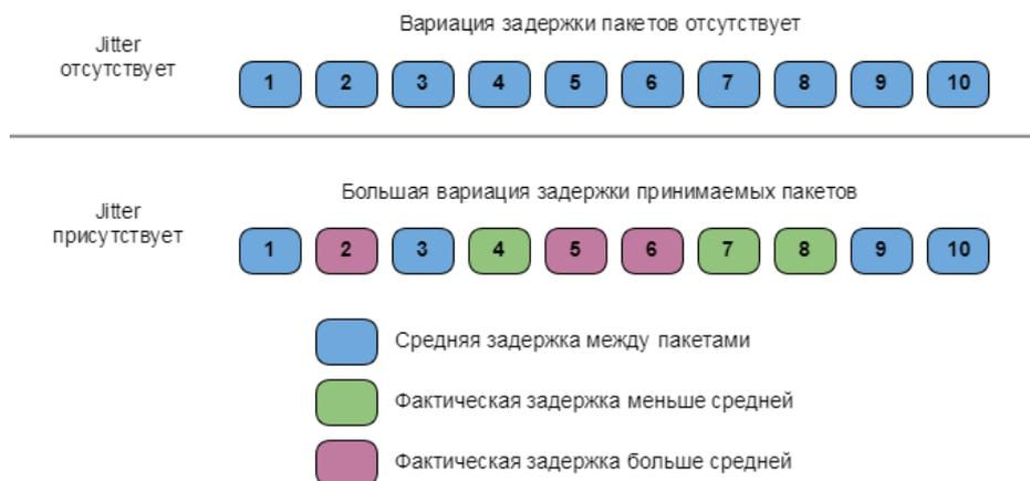
Рисунок – Пример вариации задержки в разных условиях
