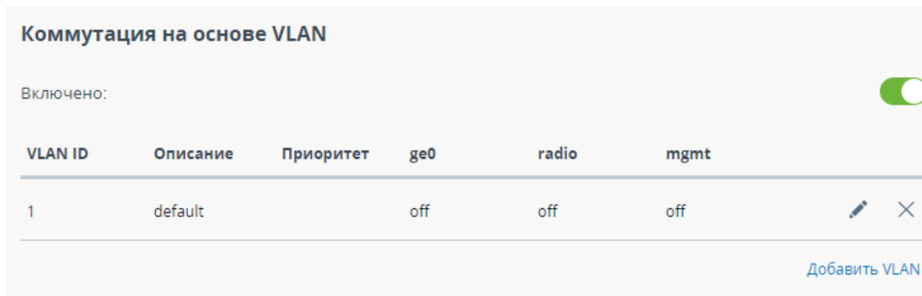
Рисунок - Настройка коммутации на основе VLAN
