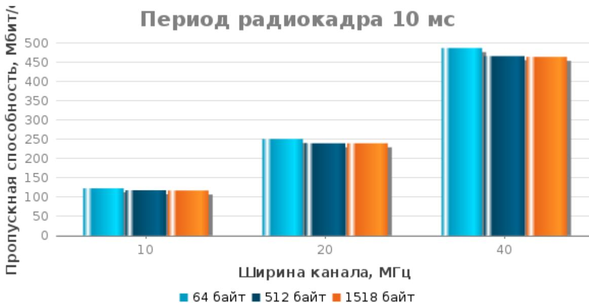
**Зависимость пропускной способности от периода радиокадра (модуляция - QAM256 30/32, Short Cyclic Prefix = 0)**
