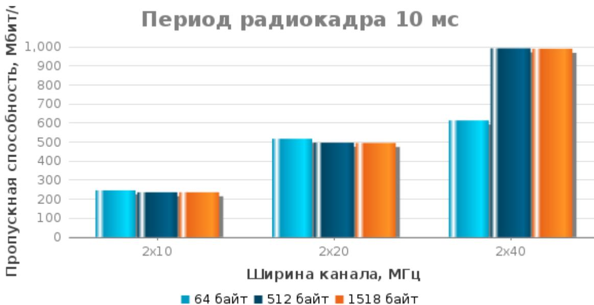
Зависимость пропускной способности от периода радиокадра (модуляция - QAM256 30/32, Short Cyclic Prefix = 1)
