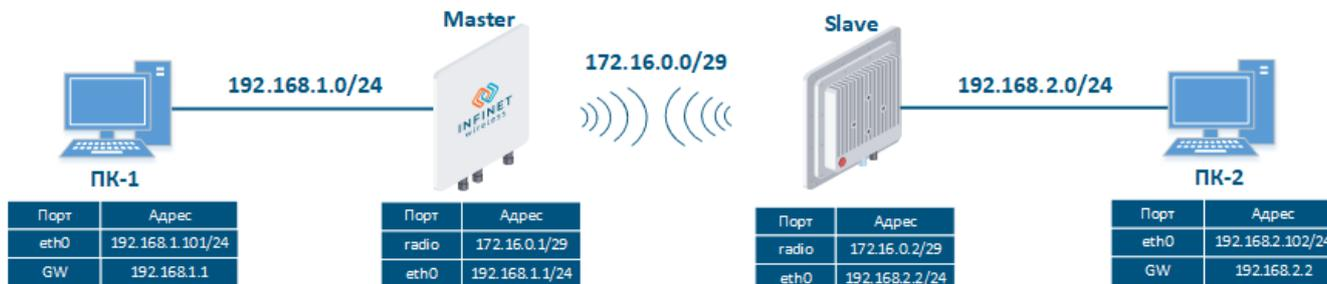
Рисунок 2 - Схема настройки маршрутизации трафика данных для устройств семейств InfiLINK 2x2, InfiMAN 2x2, InfiLINK Evolution, InfiMAN Evolution
