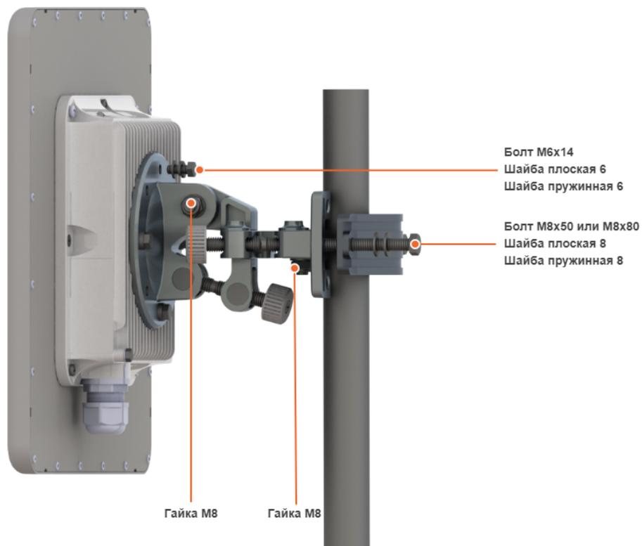
Рисунок - Схема сборки комплекта крепления
