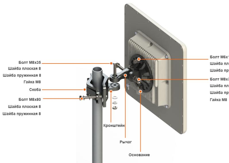
**Рисунок - Схема сборки комплекта крепления**
