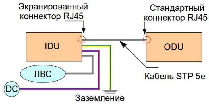
Рисунок - Схема подключения IDU-LA-G(V.01) при использовании сторонних источников питания
