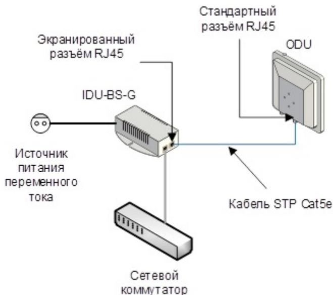
Рисунок - Схема установки IDU-BS-G/IDU-CPE и InfiNet Wireless R5000
