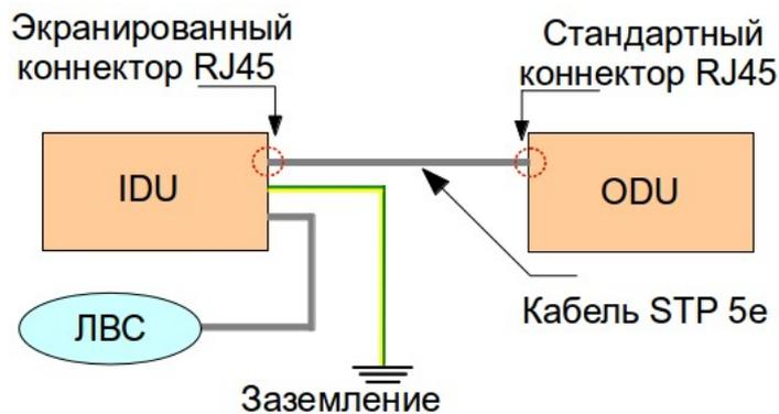
Рисунок - Схема подключения IDU-LA-G(V.01) для второго разъема RJ-45
